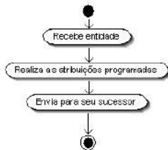
Figura 4.3: Diagrama de atividades do processo de atribuição [BER 05]
