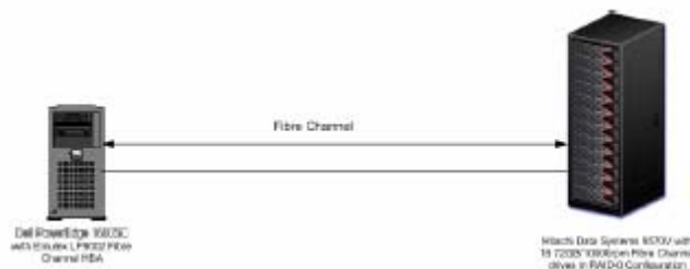
Figura 4.2: Configuração ponto-a-ponto usados nos testes com FC.
