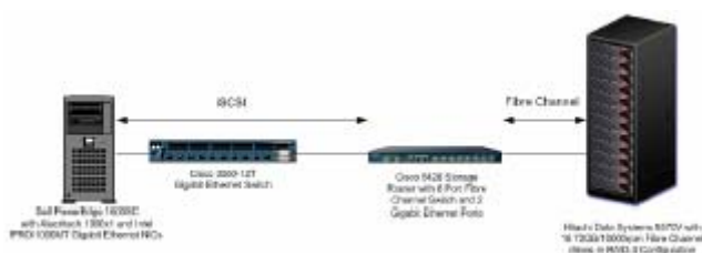
Figura 4.3: Configuração do teste iSCSI usando um roteador de armazenamento Cisco para fazer uma ponte entre iSCSI e FC.
