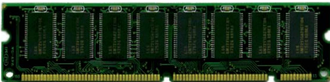
Figura 4.5: Módulo DIMM.
