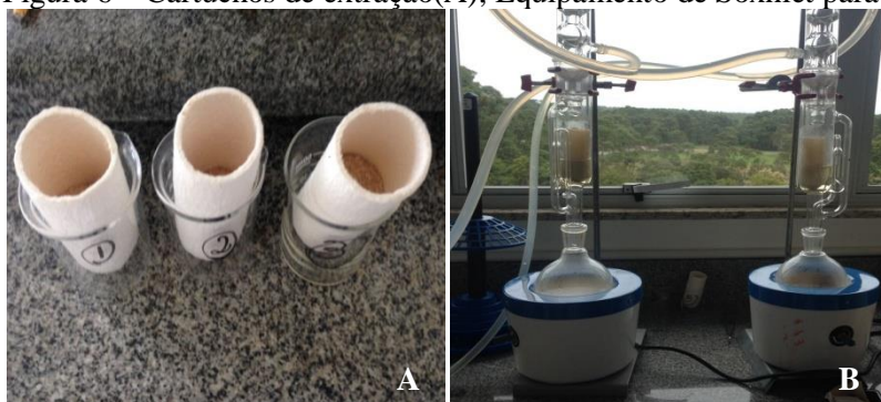
Figura 6 – Cartuchos de extração(A); Equipamento de Soxhlet para determinação de extrativos (B).
