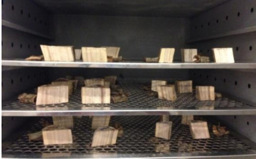
Figura 3 – Madeira e casca das cunhas na secagem em estufa a 103^{\circ}\text{C} .
