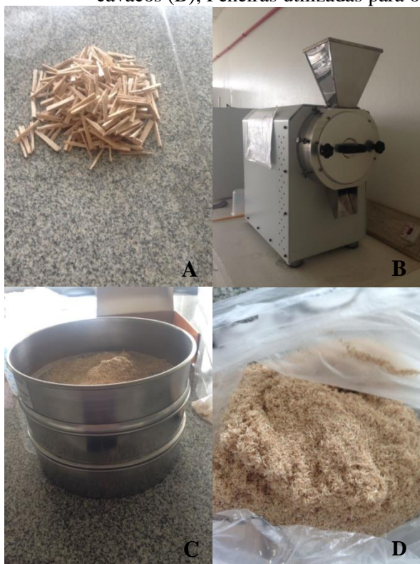
Figura 4 – Cavacos confeccionados a partir das cunhas (A); Moinho de facas utilizado para picar os cavacos (B); Peneiras utilizadas para obtenção da amostra (C); Amostra homogênea (D).
