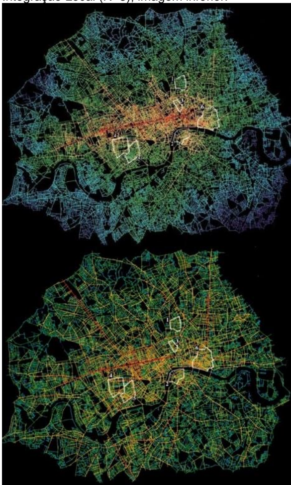
Figura 26: Mapa Axial, da cidade de Londres, com a escala cromática da análise da Integração Global, imagem superior, e análise de Integração Local (R=3), imagem inferior.
