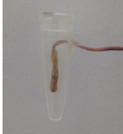
Figura 8 - Fotografia do microtubo com sensor de temperatura.
