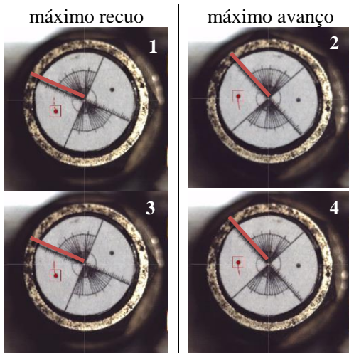
Figura 83 – Sequência de avanço e recuo do rolete durante aproximação relativa entre tocha e peça
