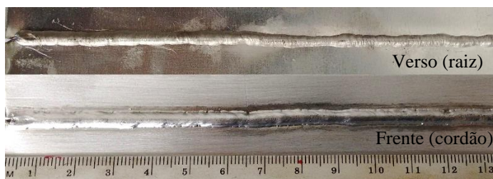
Figura 131 - Soldagem em junta de topo de chapa de 1 mm, arame ER4043 1,2 mm, velocidade de soldagem 65 cm/min
