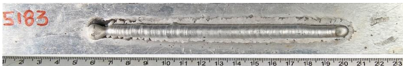
Figura 109– Depósito n°1 realizado com arame de alumínio ER5183, com 1,2 mm de diâmetro
