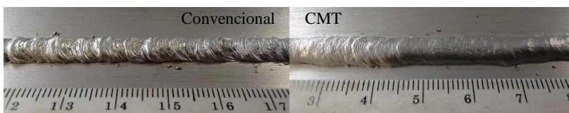
Figura 21 – Aspecto visual de depósitos de alumínio com MIG convencional e CMT
