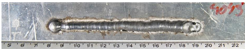
Figura 110– Depósito n°2 realizado com arame de alumínio ER4043, com 1,2 mm de diâmetro
