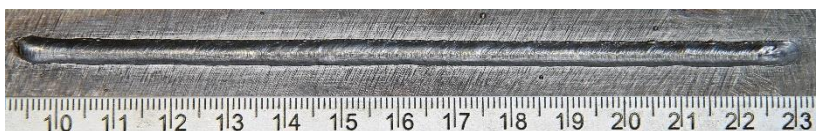
Figura 119 - Depósito de aço carbono em chapa de 2 mm correspondente a ensaio Va5 (Tabela 22)
