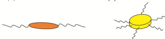
Figura 2-9 – Ilustração da característica estrutural dos CLs (a) calamíticos, com um núcleo rígido e duas cadeias flexíveis e dos CLs (b) discóticos, com um núcleo rígido e seis cadeias flexíveis.
