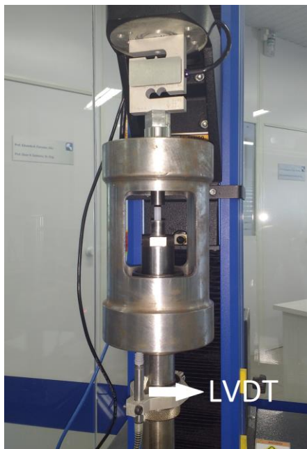
Figura 5.5 – Dispositivo de ensaio e sistema de fixação do LVDT
