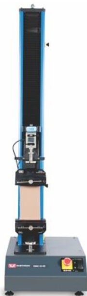
Figura 5.1 – Máquina de ensaios Instron EMIC 23-5S usada nos ensaios cíclicos. Fonte: Emic Website [18]
