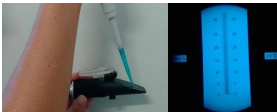
Figura 3: Refratômetro de Brix óptico e escala interna do refratômetro.
