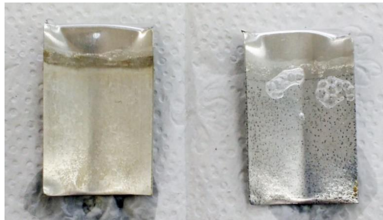
Figura 14 – Eletrodos de sacrifício. A esquerda o ânodo e a direita o cátodo.
