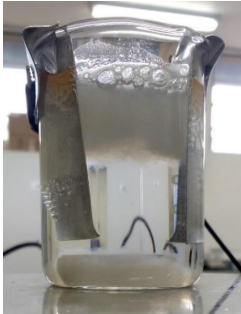
Figura 13 – Flocos insolúveis coagulados, transparência da água e formação de gás hidrogênio no cátodo.
