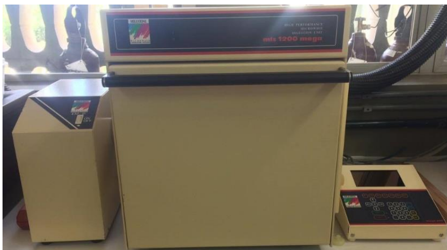
Figura 6. Micro-ondas MLS 1200 MEGA utilizado no processo de digestão.
