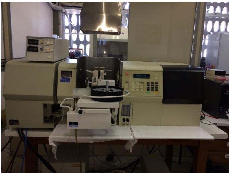
Figura 5. Espectrômetro de absorção atômica com fonte de Linha, Modelo AAnalystPerkinElmer.
