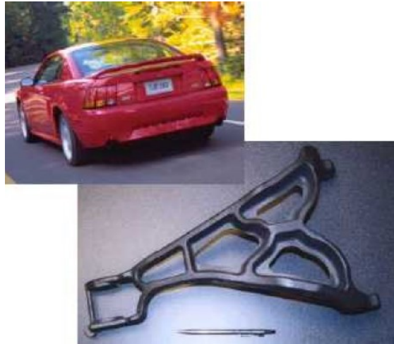
Figura 17 – Braço da suspensão de um veículo de passeio.
