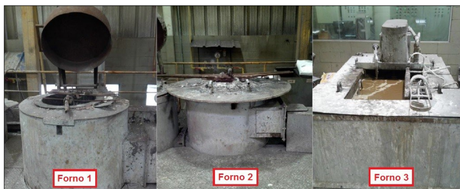
Figura 22 - Fornos utilizados para o tratamento térmico. Legenda: (1) forno para pré-aquecimento, (2) forno banho de sais para austenitização e (3) forno com banhos de sais para austêmpera.
