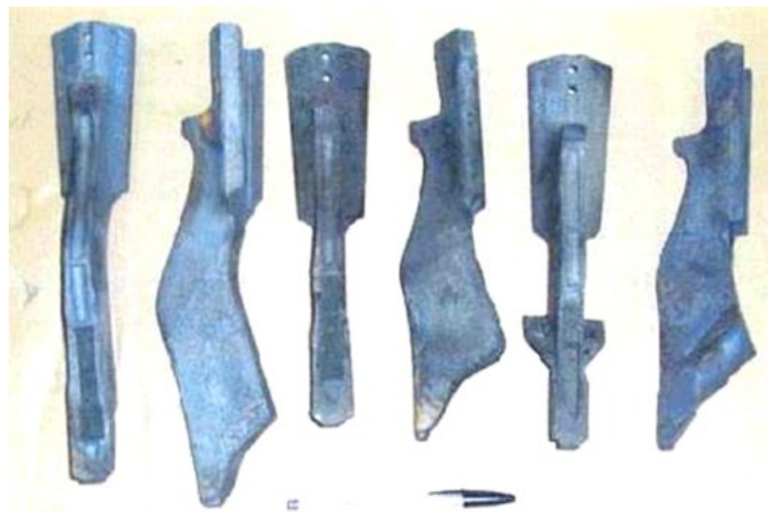
Figura 18 – Dentes de escavação fabricados em ADI.
