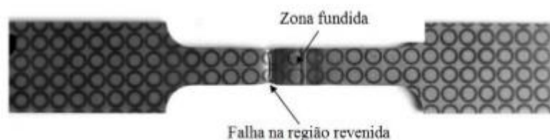
Figura 6- Corpo de prova de tração ensaiado com falha na região revenida.
