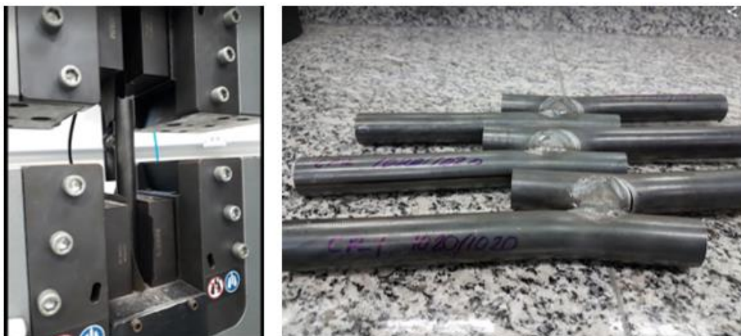
Figura 26 - Locais preferenciais para a ocorrência de ruptura em corpos de prova em "H".
