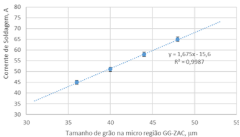
Figura 20 - Relação entre o tamanho médio de grãos na micro-região GG ZAC com a intensidade de corrente durante soldagem de juntas planas de aço DualPhase 980.
