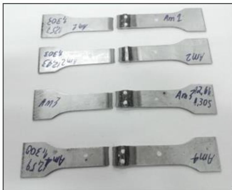
Figura 23 – Corpos de prova apresentando ruptura na zona afetada pelo calor em juntas planas de aços DualPhase 980.
