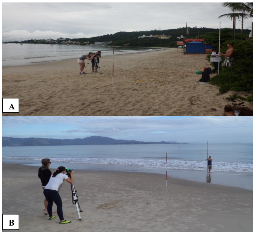
Figura 19. Levantamento altimétrico no arco praial de Jurerê. A - visada horizontal no sentido "ré" do perfil (Foto de Norberto Olmiro Horn Filho, fevereiro de 2016). B - visada horizontal no sentido "vante" (Foto de Norberto Olmiro Horn Filho, novembro de 2015).
