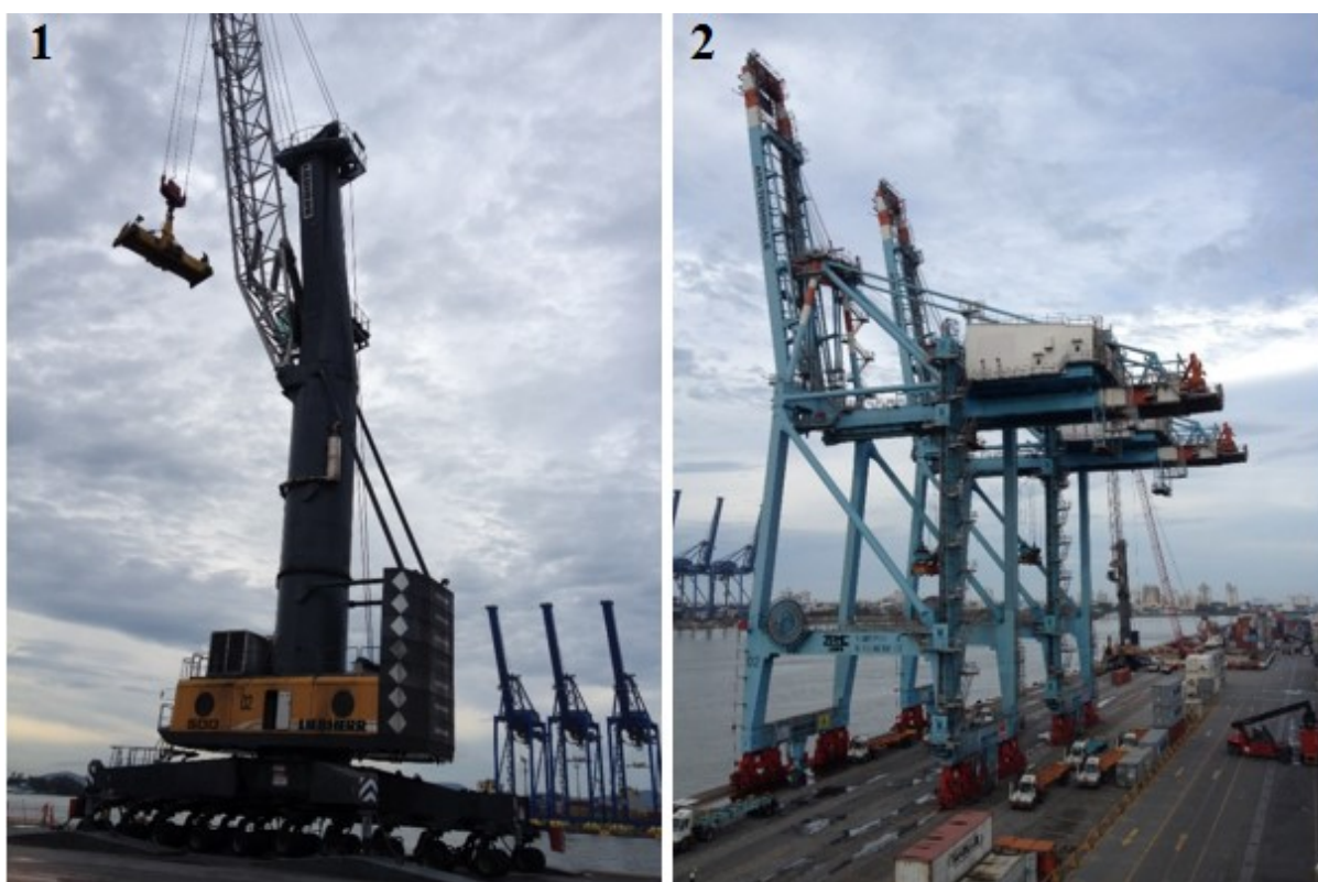
Figura 15: Guindaste Mobile Harbor Crane (1); Portêiner pós-Panamax (2).
