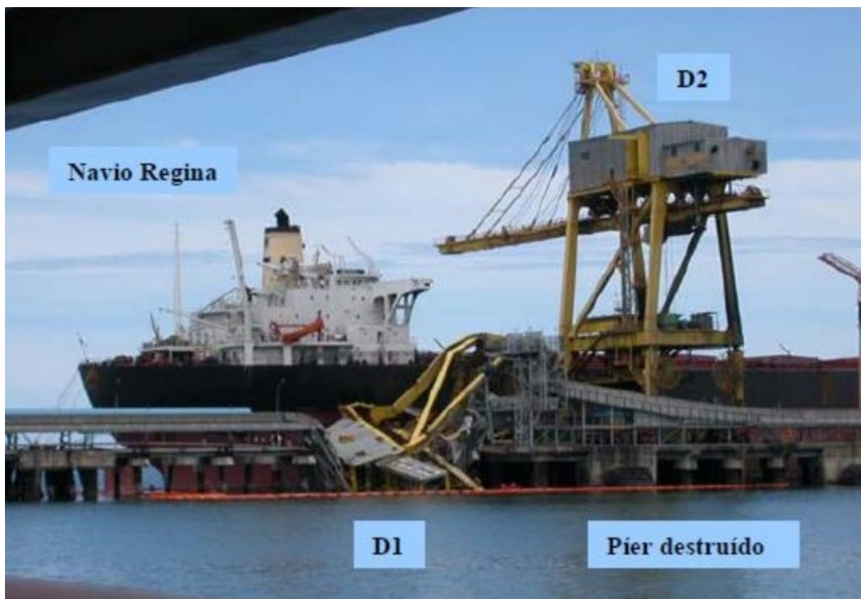
Figura 8: Acidente com o descarregador de minério no Porto de Sepetiba.
