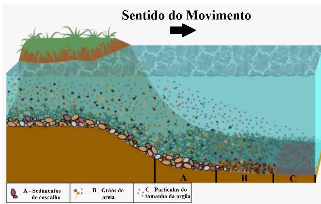
Figura 7: Transporte de sedimentos por correntes em um rio.
