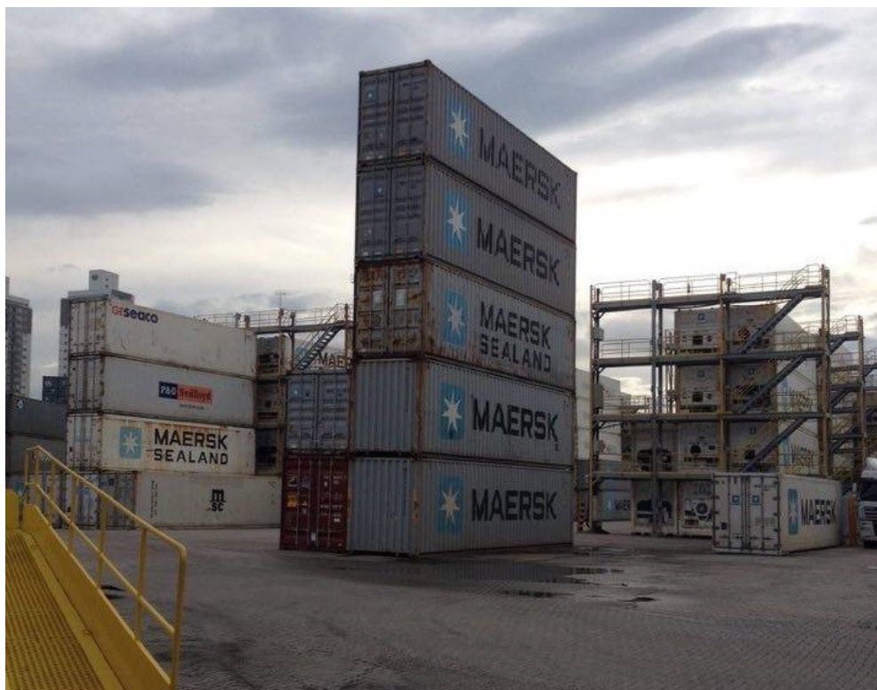
Figura 28: Distribuição irregular dos contêineres quanto a carga resultante do vento.
