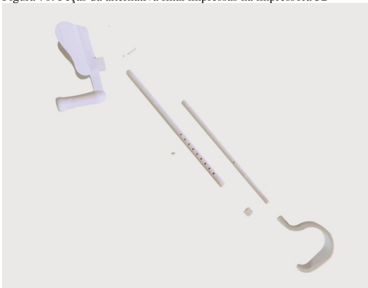
Figura 70: Peças da alternativa final impressas na impressora 3D
