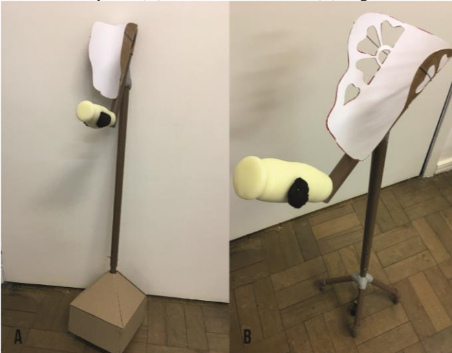
Figura 53: Primeiros modelos de dispositivos auxiliares de marcha com estrutura completa: (A) Primeira alternativa. (B) Segunda alternativa.
