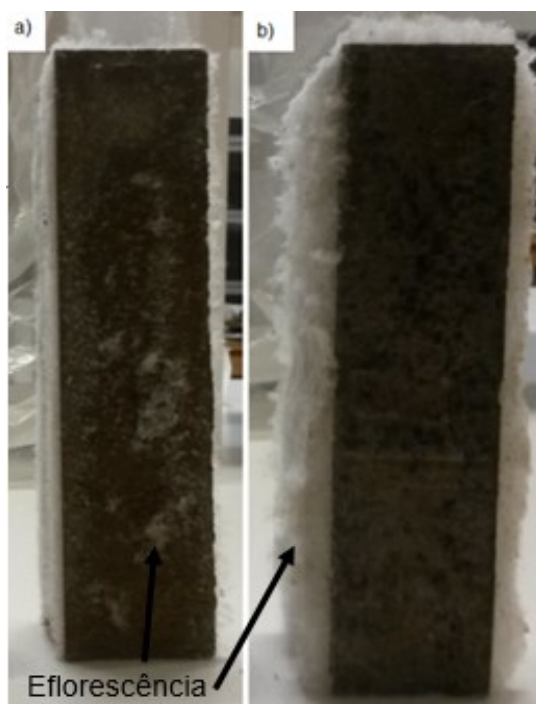
Figura 24 – Amostras com valores diferentes de s/l a) s/l=1,4 b) s/l=1,2
