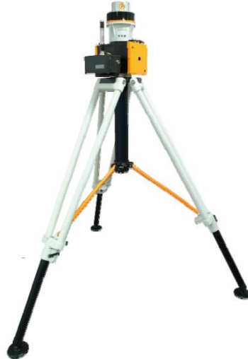
Figura 27: Tripé para transmissores
