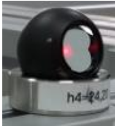
Figura 32: Spherical mounted cube-corner reflector (SMR) – Alvo refletor da estação total.
