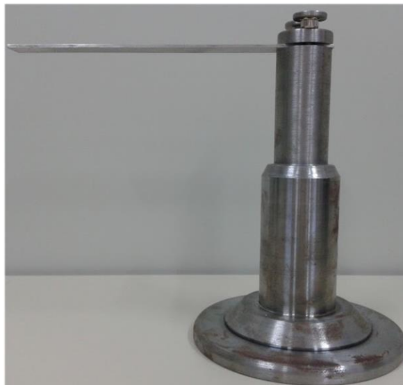
Figura 37 – Corpo de prova para medição de deformação longitudinal
