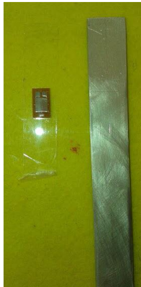
Figura 39 – Extensômetro e o processo de fixação.
