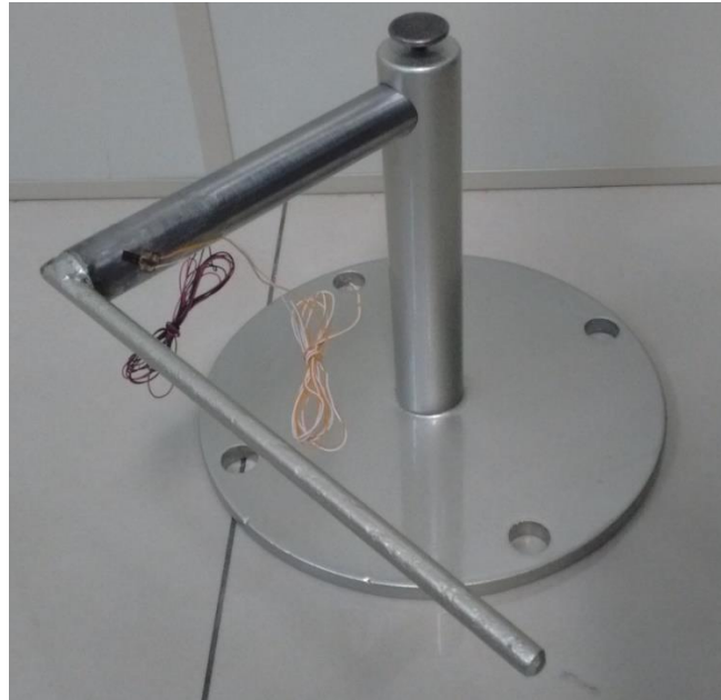
Figura 46 – Corpo de prova para medição de deformação angular.
