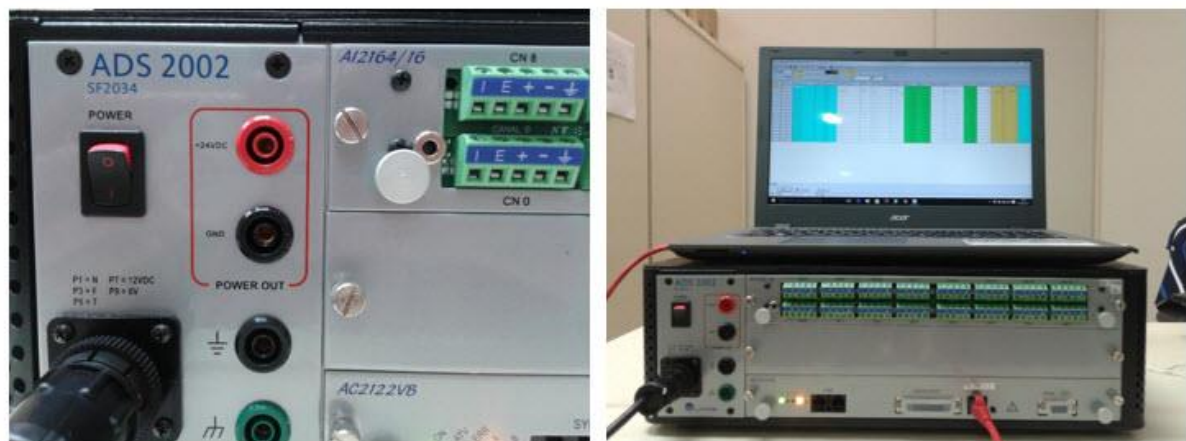
Figura 33 – Equipamento de aquisição de dados LYNX 2002.
