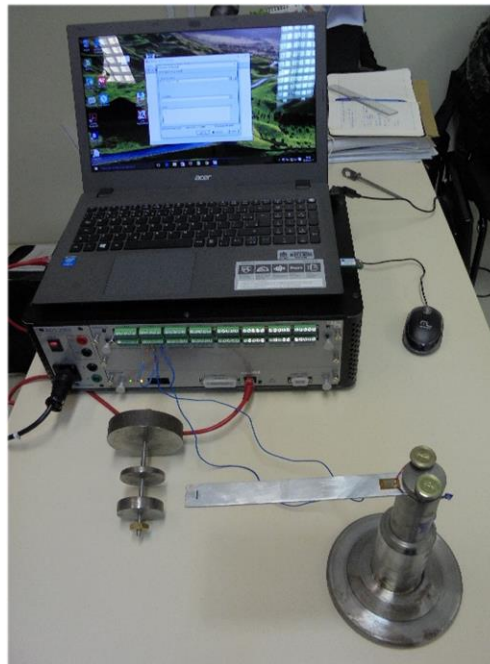
Figura 52 – Corpo de prova conectado ao sistema de medição.
