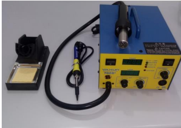
Figura 40 – Estação de solda.
