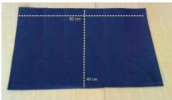
Figura 20 - Base de E.V.A. para o posicionamento e a coleta de imagem térmica.
