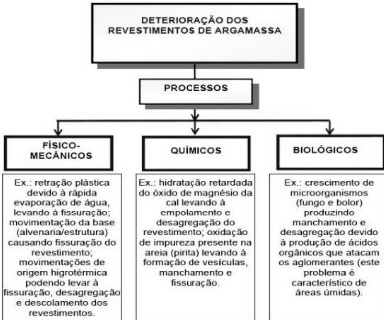
Figura 12 - Processo de deterioração dos revestimentos argamassados
