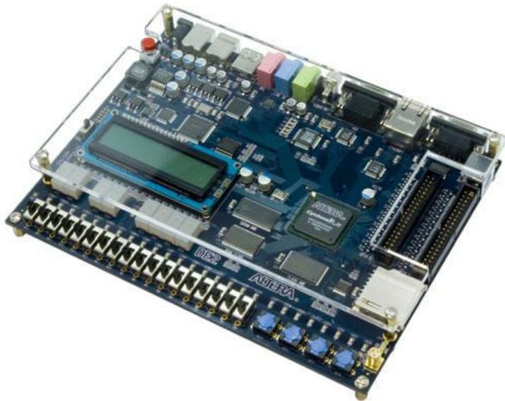
FIGURA 18 - KIT DE DESENVOLVIMENTO DE2 DA ALTERA CONTENDO UMA CYCLONE® II.
