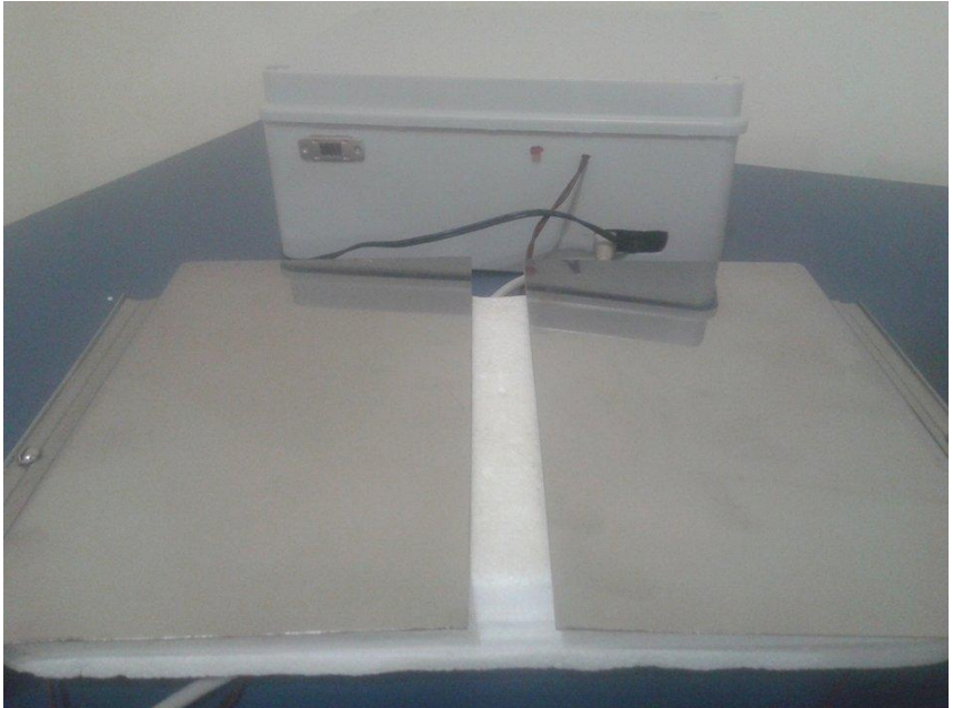
FIGURA 20—ELETRODOS DE AÇO INOXIDÁVEL UTILIZADO PARA MEDIR IMPEDÂNCIA DE MÃOS E PÉS.
