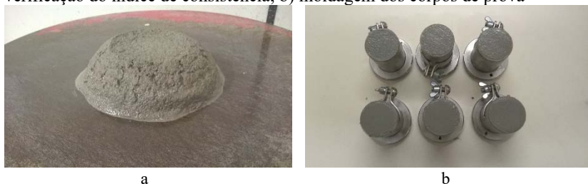
Figura 12: Ensaio de índice de desempenho com cimento Portland: a) verificação do índice de consistência; b) moldagem dos corpos de prova
