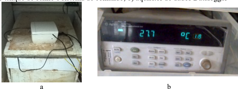
Figura 20: Equipamentos utilizados no ensaio de calorimetria: a) vista externa do tanque de banho e sistema de comando; b) aquisitor de dados Datalogger
