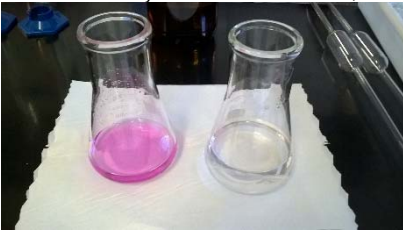
Figura 13: Titulação da solução filtrada com HCl (frasco à esquerda, solução antes da titulação e frasco à direita, solução após titulação)
