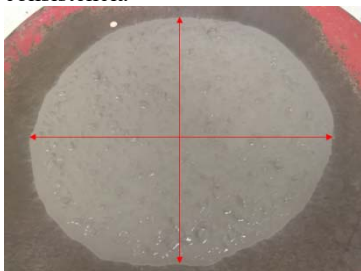
Figura 14: Verificação do espalhamento do CAA na mesa para índice de consistência
