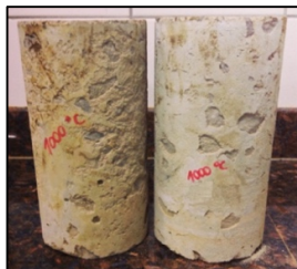
Figura 3.7: Concreto após exposição a 1000 °C
