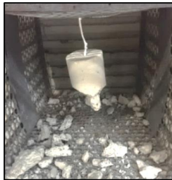
Figura 6.1: Corpo de prova que sofreu spalling após o aquecimento
