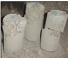
Figura 3.4: Desagregação de concretos com baixa compactidade a 900 °C após o transporte Fonte: LIMA (2005)
