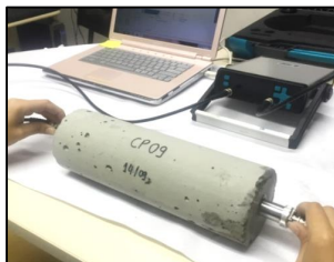
Figura 5.10: Método da transmissão direta em corpos de prova
