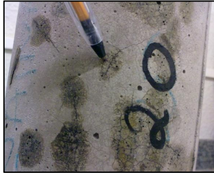
Figura 3.6: Fissuras no corpo de prova após exposição a 400 °C Fonte: SILVA (2013)
