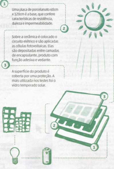
Circuito elétrico é instalado em placas de cerâmica que também são utilizadas para compor o design dos prédios
