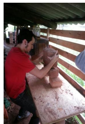
Foto 4: Imagem do ensaio do empilhamento
