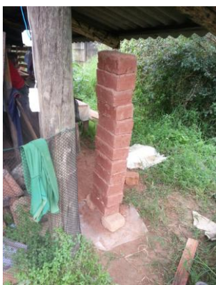
Foto 3: Imagem do ensaio do empilhamento
