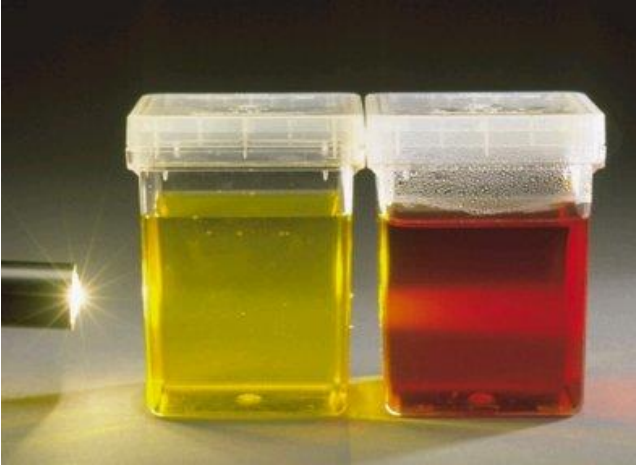
Figura 4 – Ilustração do efeito de Tyndall produzido por dispersões coloidais. Dispersão de nanopartículas de Ag (em amarelo) e dispersão de nanopartículas de Au (em vermelho)
