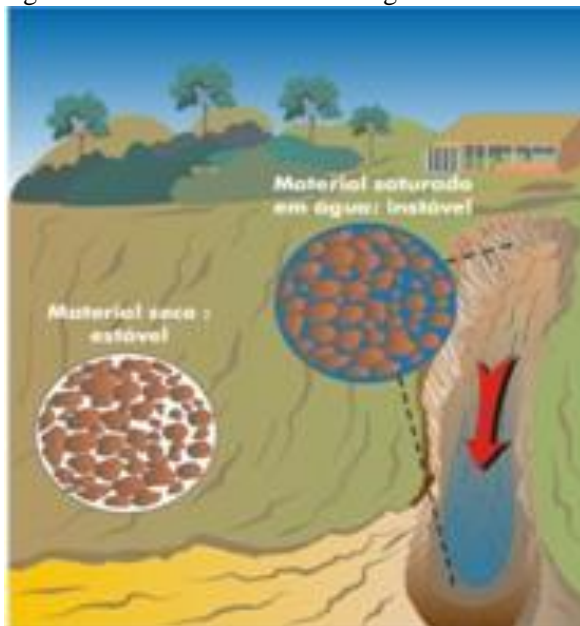
Figura 3-7 - Escorregamento translacional padrão
