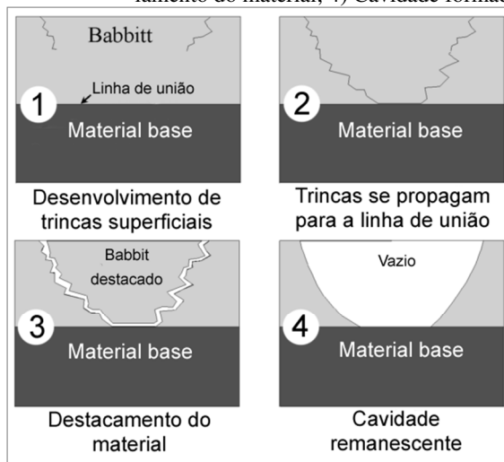
Figura 2.5 – Formação de trincas em material com variação abrupta de composição: 1) Nucleação da trinca; 2) Propagação da trinca; 3) Descolamento do material; 4) Cavidade formada.
