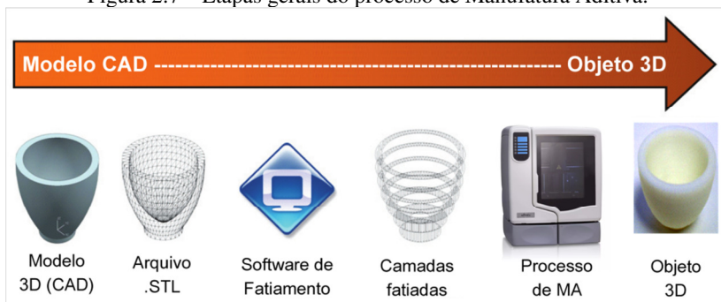
Figura 2.7 – Etapas gerais do processo de Manufatura Aditiva.
