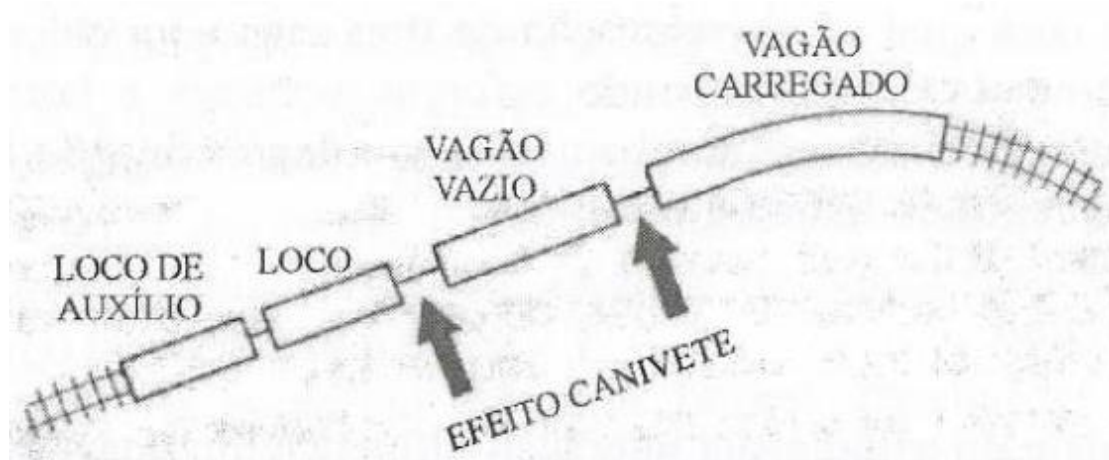
Figura 32 – Representação esquemática de uma locomotiva de auxílio empurrando vagões leves contra vagões pesados.
