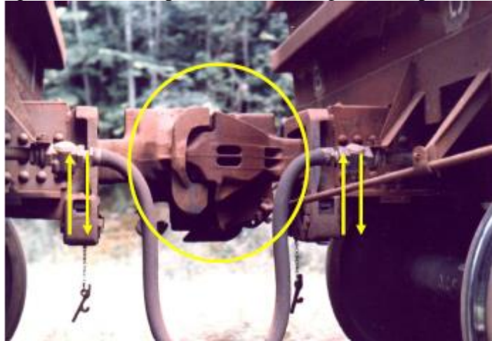
Figura 11 – Fotografia de um acoplamento entre engates do tipo F e sua flexibilidade.
