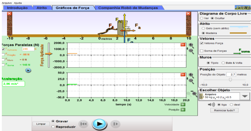
Figura 2.3: Aceleração com somatório de forças positivo, com força de atrito cinética
