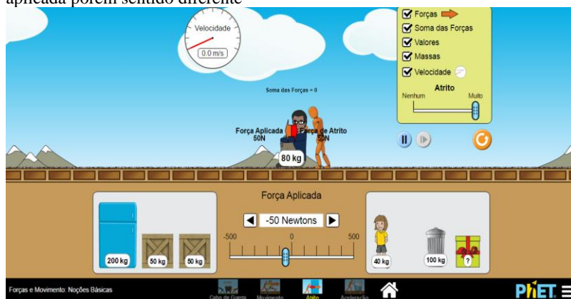
Figura 3.7: Enfatizando que a força de atrito tem mesma direção da força aplicada porém sentido diferente
