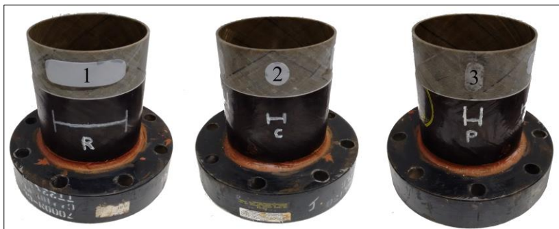
Figura 6.26 – Tamanho, forma e tipo de defeito inserido na região da junta ponta e bolsa. (1) Defeito retangular com lâmina de teflon; (2) Defeito circular com lâmina de teflon; (3) Defeito elíptico com parafina.
