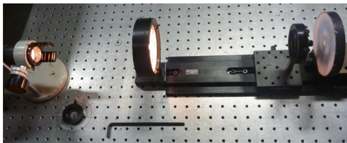
Figura 4.6 – Aparato para obtenção da curva característica da microlente.
