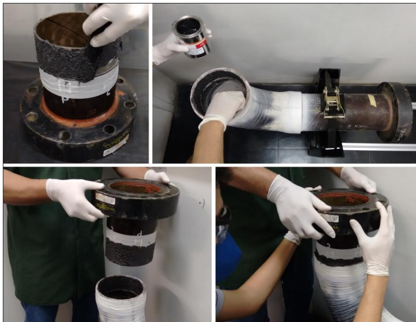
Figura 6.27 – Montagem do corpo de prova CP0, com os defeitos artificialmente inseridos na região da união.
