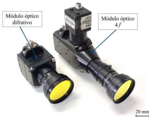
Figura 4.19 – Comparação entre os módulos de formação e aquisição de imagem difrativo e 4f .
