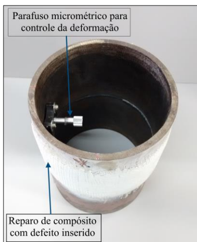
Figura 6.34 – Defeito com controle de deformação por parafuso micrométrico.
