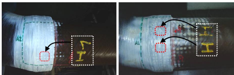
Figura 6.23 – Identificação das posições, tamanhos e tipos de defeitos inseridos nas interfaces das juntas ponta e bolsa do corpo de prova CP3.
