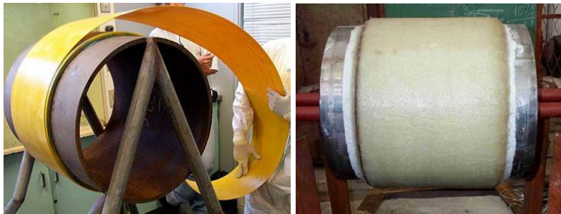
Figura 2.2 – Aplicação de material compósito em segmento de tubo de aço [10].
