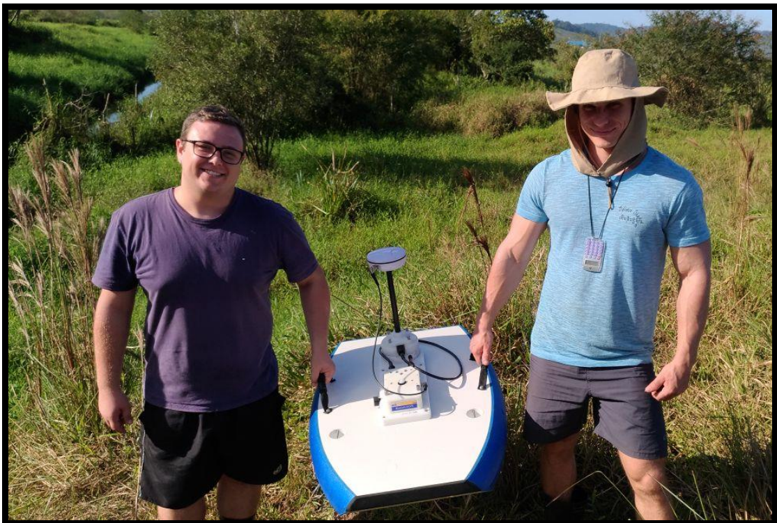
Figura 19 - ADCP pronto para realização de medição
