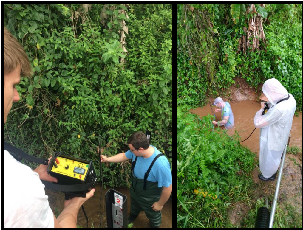
Figura 16 - Processo de medição com micro-molinete hidrométrico
