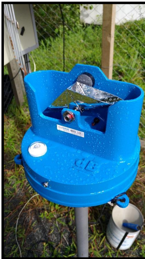
Figura 7 - Modelo de pluviógrafo de cubas basculantes
