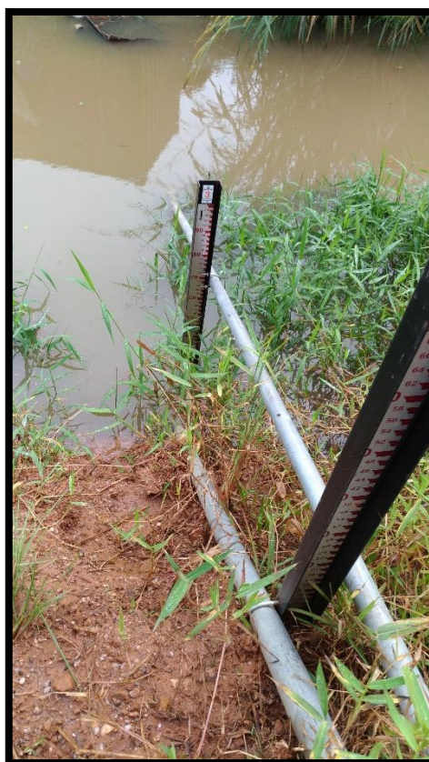
Figura 5 - Modelo de linímetro usado nos pontos de medição
