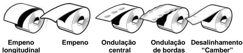
Figura 8 – Os principais defeitos de forma.
