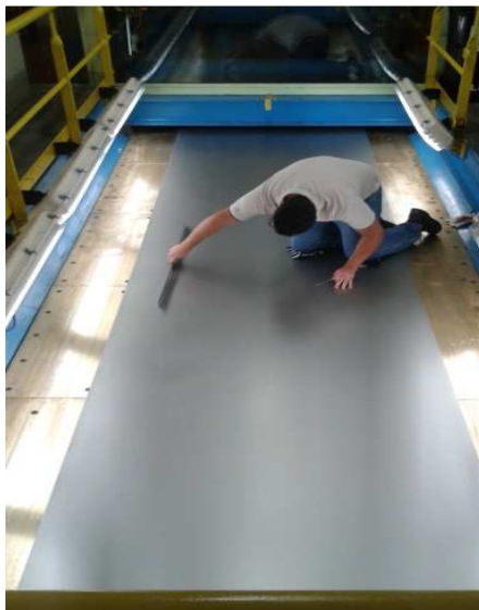
Figura 32 – Mesa de inspeção de uma linha de inspeção.
