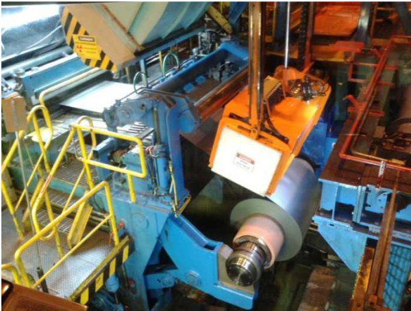
Figura 14 – Inspeção visual da planicidade em uma linha de encruamento.
