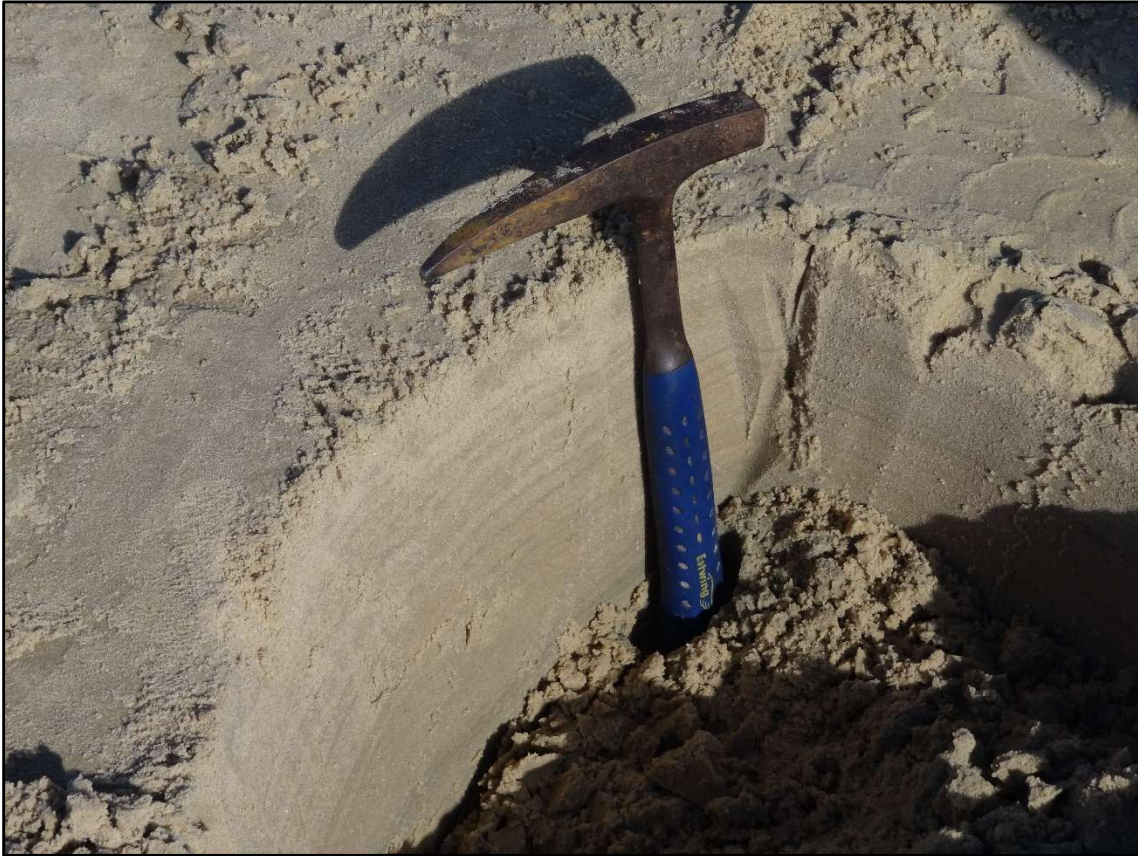
Foto 34: Detalhe do sedimento arenoso fino, bem selecionado e estratificado da amostra SMG#20 coletada na praia da Cigana. Foto de Norberto Olmiro Horn Filho (15/4/2016).
