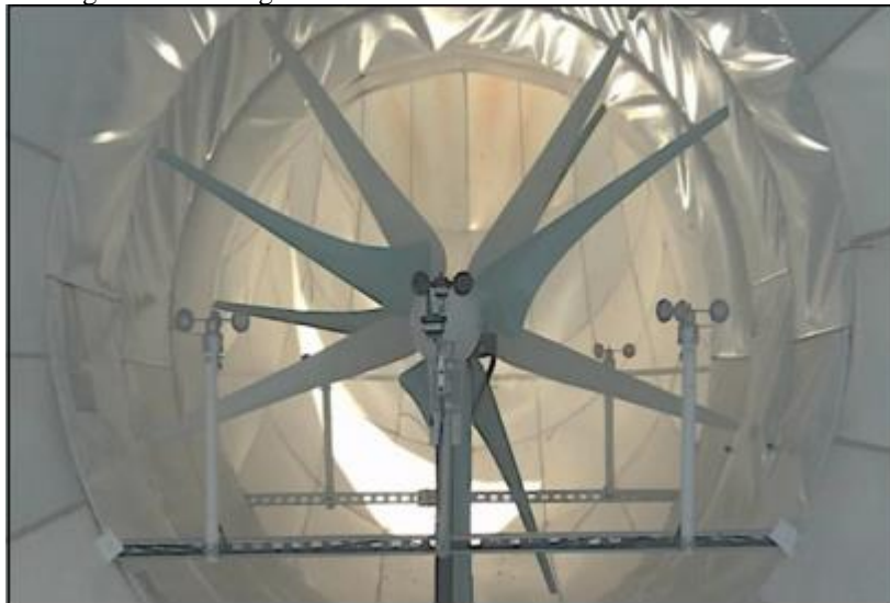
Figura 29 - Três geradores de turbinas eólicas instaladas no Venturi
