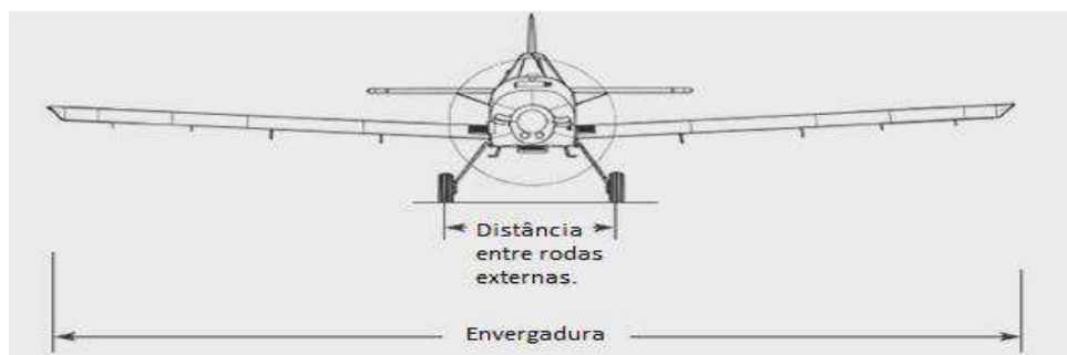
Figura 1: Distância entre rodas e envergadura
