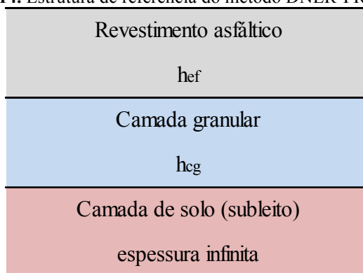
Figura 14. Estrutura de referência do método DNER-PRO 269/94
