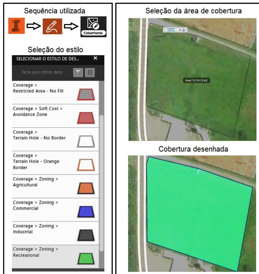
Figura 13 – Sequência utilizada para o desenho de uma cobertura no InfraWorks.
