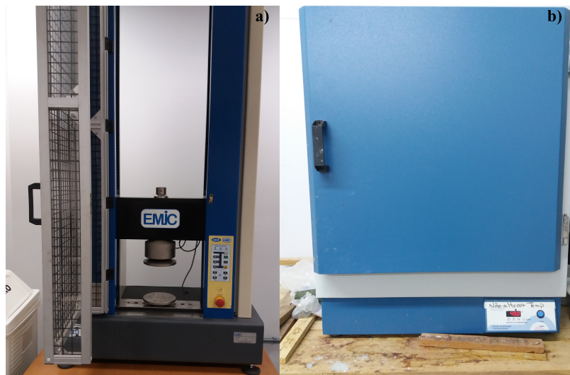
Figura 16 – Equipamentos utilizados no estado endurecido – a) Máquina universal para ensaios mecânicos, b) Estufa.
