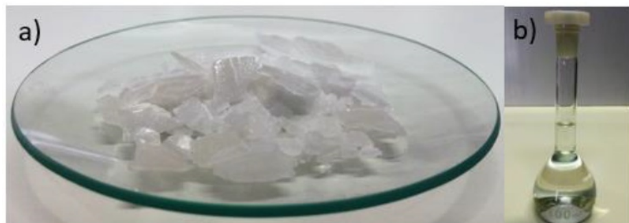
Figura 13- a) Hidróxido de sódio b) Solução ativadora pronta.
