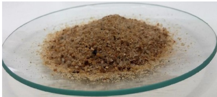
Figura 8 – Areia utilizada para a produção das argamassas geopoliméricas.
