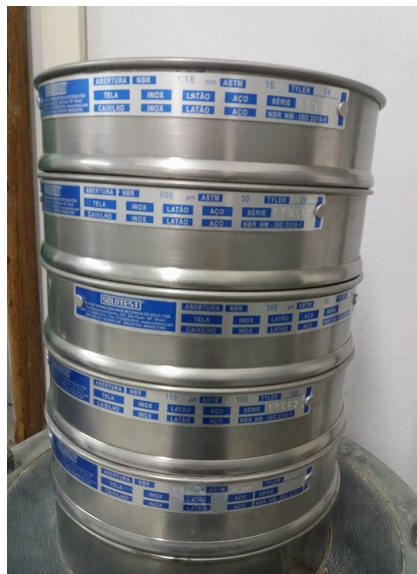
Figura 12 – Peneiras utilizadas para fazer a granulometria do concreto reciclado utilizado para produção das argamassas geopoliméricas.
