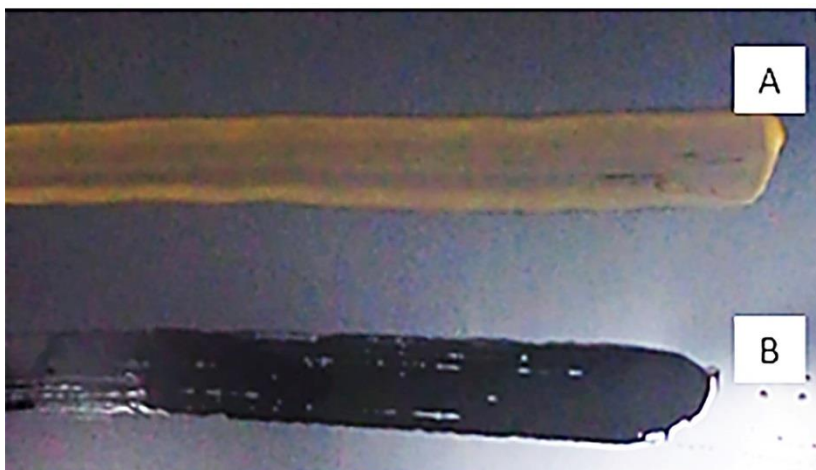
Figura 27 - Resultado do teste Dyne Inks após o tratamento de flambagem velocidade 925 mm/seg, (A) - 48 dines e (B) - 50 dines.
