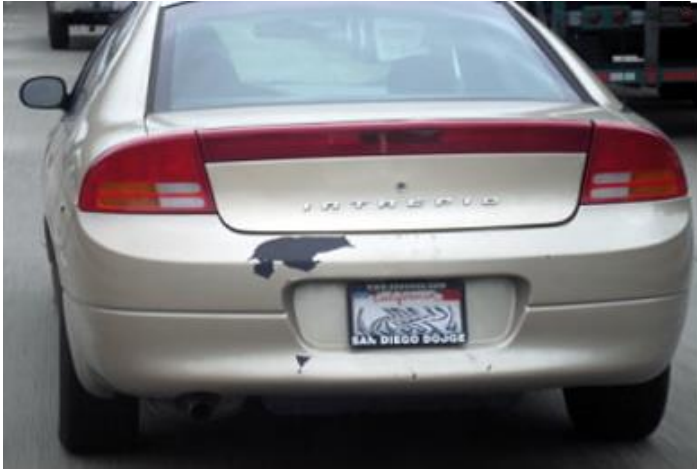
Figura 3 - Exemplo de parachoque com defeito de descolamento de pintura.
