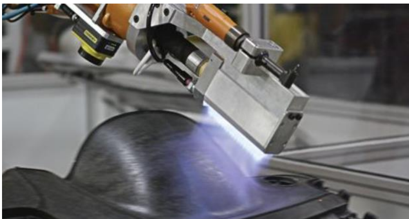
Figura 8 – Processo de flambagem aplicado por robô equipado com queimador.
