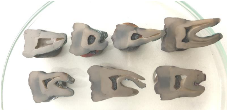
Figura 20: Amostras posicionados nos stubs e recobertos com carbono.
