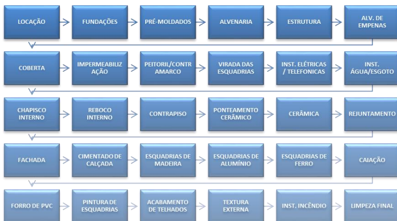
Figura 38 - Sequência de serviços na unidade-base.
