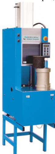
Figura 23 - Compactador Giratório Servopac, fabricado pela IPC Global®.
