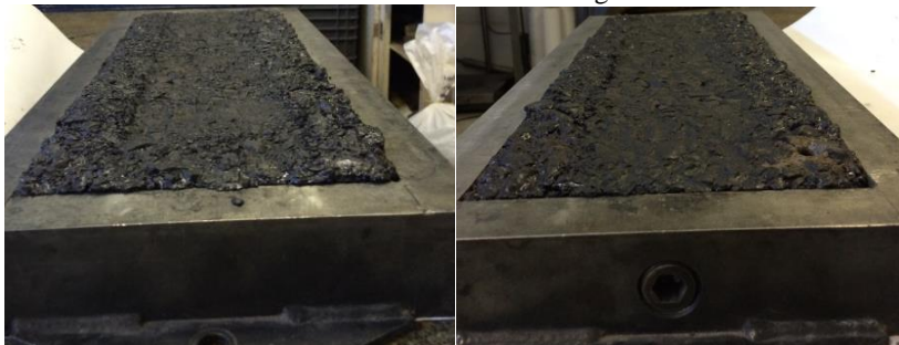
Figura 36 - Placas de mistura asfáltica modificada com polímero SBS, após ensaio no simulador de tráfego.
