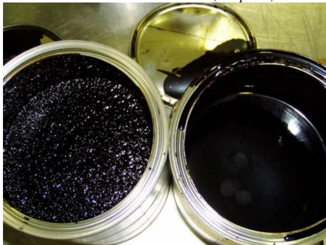
Figura 4 - Diferença aparente entre asfalto-borracha estocável (à direita) e asfalto-borracha não-estocável (à esquerda).
