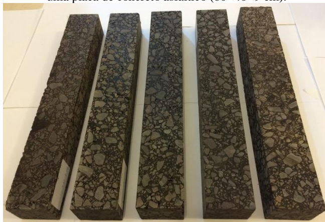
Figura 34 - Corpos de prova prismáticos (400,0×50,8×63,5 mm) serrados de uma placa de concreto asfáltico (60×40×9 cm).
