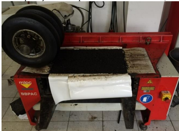
Figura 33 - Compactação de uma placa de concreto asfáltico (60×40×9 cm).
