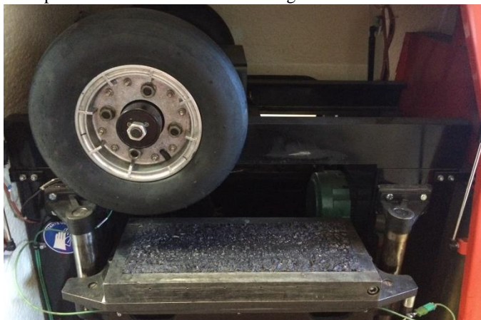
Figura 35 - Placa de concreto asfáltico durante ensaio de deformação permanente no simulador de tráfego francês Orniéreur .
