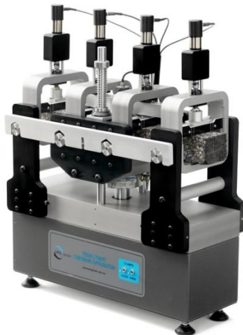
Figura 26 - Aparato 4 pontos, desenvolvido pela IPC Global ® .
