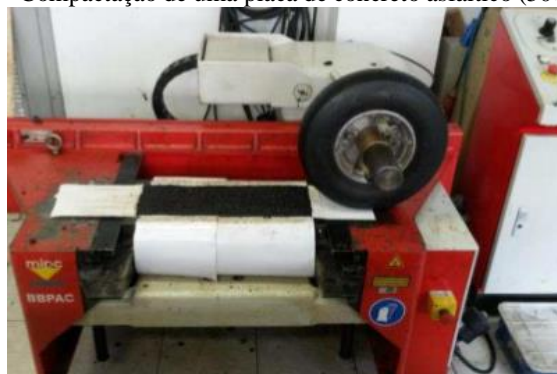
Figura 32 - Compactação de uma placa de concreto asfáltico (50×18×5 cm).
