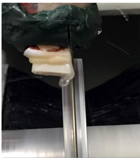
Figura 33 - Conjunto dente/cimento/bloco sendo cortado
