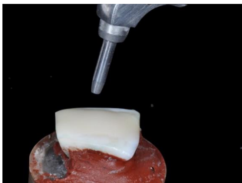
Figura 22 – Jateamento do grupo SDIS para limpeza da superfície
