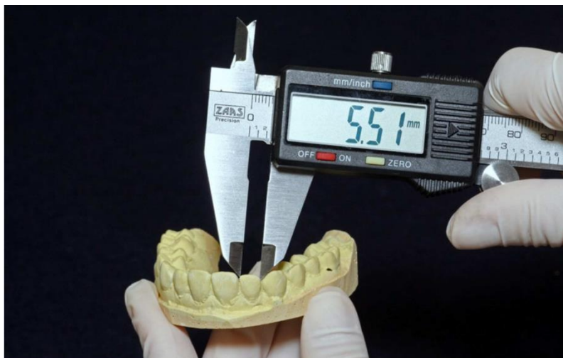
Figura 7. Análise métrica utilizando método do paquímetro digital. Fonte: Araújo, 2014.
