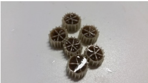
Figura 5 – Biomassa aderida no material suporte AMB BioMedia™ do BRMBS-LM
