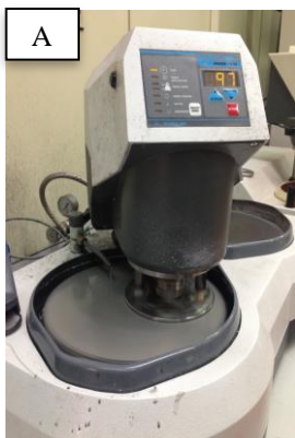
Imagem 14. Polidora Phoenix beta (Buehler, Illinois, EUA) (A); Amostras polidas prontas para serem analisadas mediante DRX (B).
