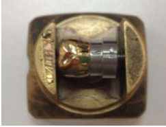
Imagem 9. Dispositivo de metal para prender as amostras sempre na mesma posição
