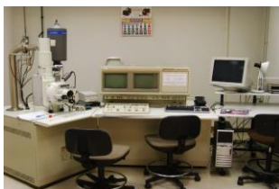
Imagem 6. Microscópio eletrônico de varredura (JSM-6400, Jeol, Espanha, Madrid)
