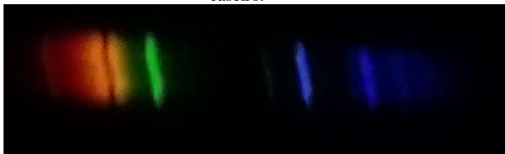
Figura 14 - Espectro de emissão visto pelos alunos através do espectrômetro caseiro.
